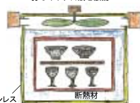
2重ブランケット構造 外側：比熱の小さい断熱材 内側：製品と同じ性質の素材
