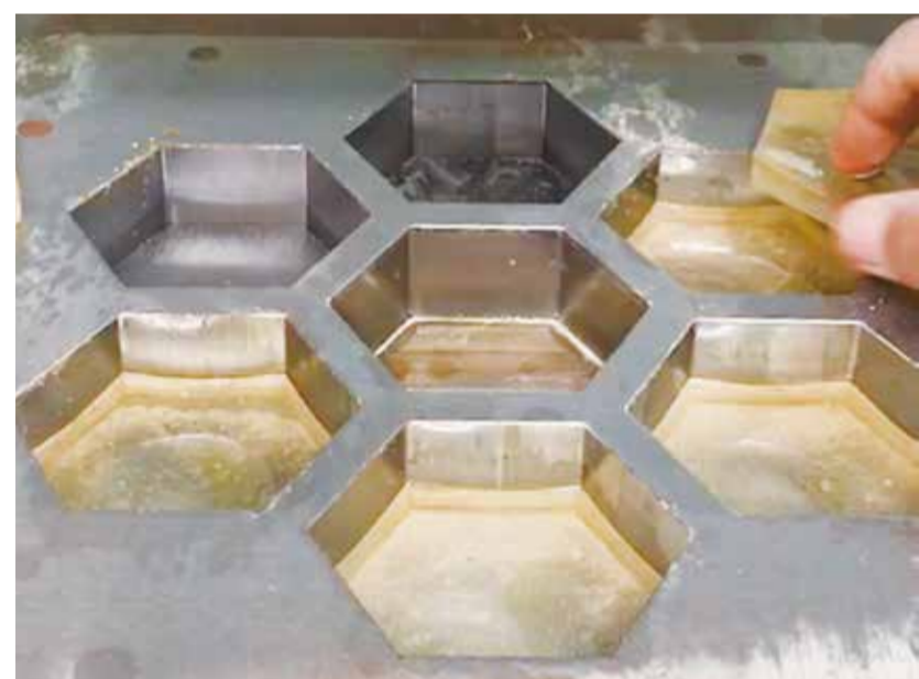
▲ 樹脂型を利用した乾式プレス成形の様子
