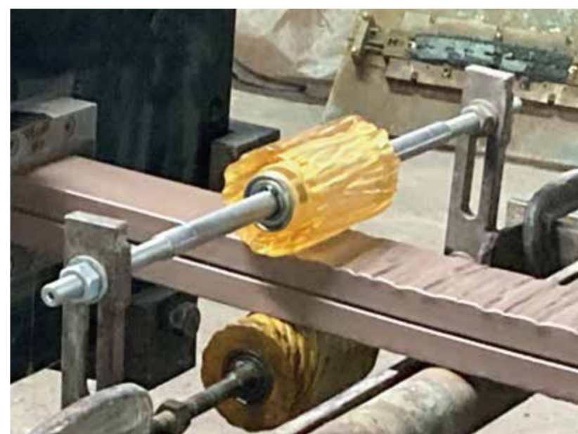
▲ 樹脂ローラーを使用した湿式押出成形の様子
