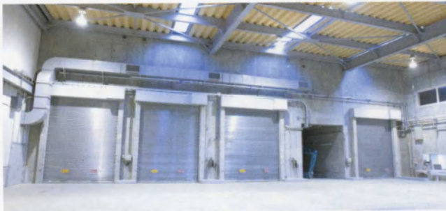
■プラットホーム 破碎ごみ・粗大ごみ・飲料缶は、リサイクルプラザ内のプラットホーム に持ち込まれ、それぞれの選別ラインへと送られます。
