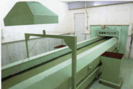
■手選別コンベヤ(飲料缶用) 飲料缶に混ざって出された異物を手選別で 取り除きます。
