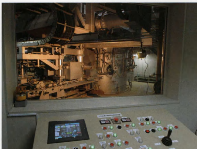
■ 炉前操作室 出湯作業は炉前作業室より安全に遠隔操作します。
