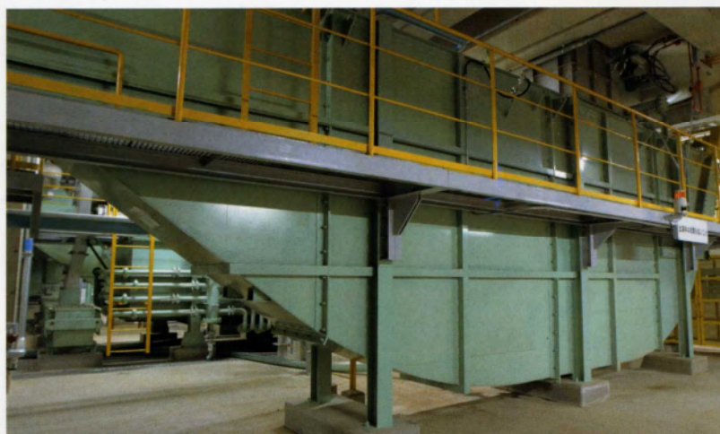
■水砕ピット 溶融炉直下に位置し、出湯した溶融物を急速冷却(水砕)します。冷却後の溶融物は揺上コンベヤにて磁選機へ搬送されます。
