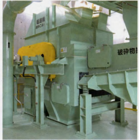
■磁選機（破碎ごみ用） 破碎されたものの中から鉄類を取り出します。
