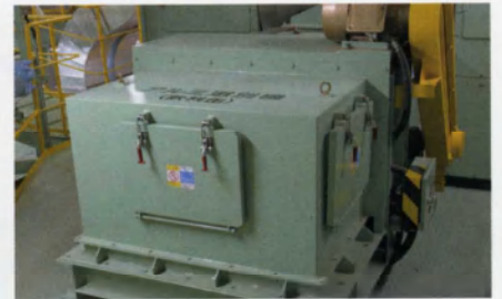
■アルミ選別機(飲料缶用) 永久磁石を高速回転させ、発生した渦電流と 磁界の作用により、アルミ缶を前方に弾き飛 ばして選別します。
