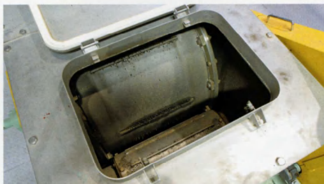
■磁選機 溶融物はここでスラグとメタルに分離し、それぞれのホッパに貯留されます。
