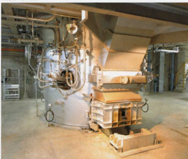
■ 溶融炉 炉内に投入されたごみは高温溶融処理され、溶融物となって出湯口より定期的に排出されます。
