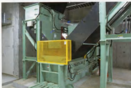
■鉄・アルミプレス機(飲料缶用) アルミ缶・スチール缶をそれぞれをブロック状 に圧縮成型します。
