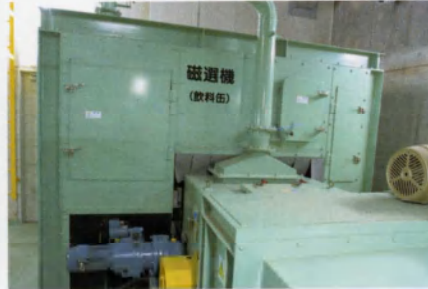
■磁選機(飲料缶用) スチール缶を磁石に吸着させて選別します。
