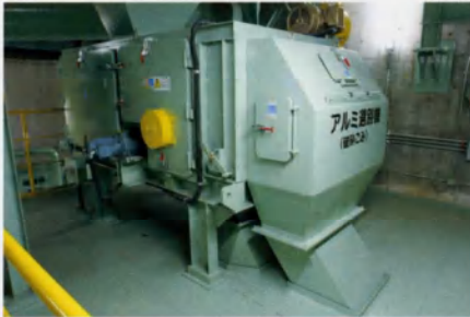
■アルミ選別機（破碎ごみ用） アルミ類と可燃物を選別します。
