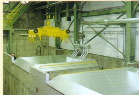
■ごみクレーン・ホッパ ごみは、ごみピット内で、クレーンで均一に攪拌され、ホッパより炉内に供給されます。
