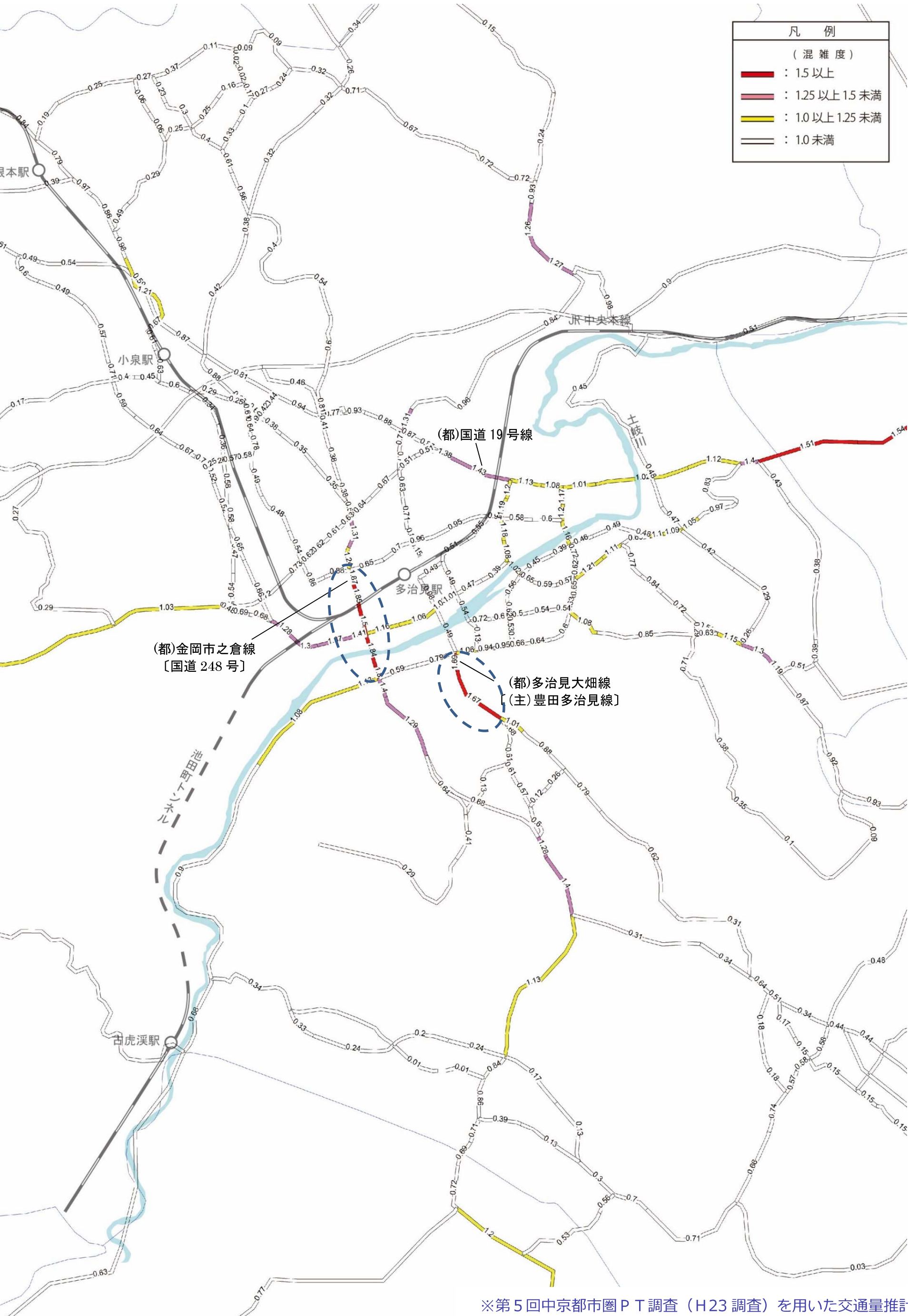
図 3・10 将来道路網に対する将来交通量推計結果〔混雑度図〕
