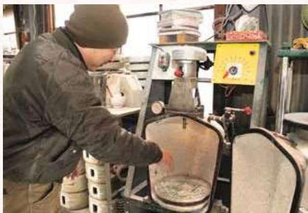
▲須田式攪拌機。石こうに水を加え、回転させることで気泡を抜くこの機械は、40年以上も使い続けている市原製型所のオリジナル。
