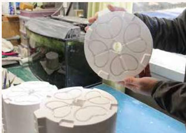
▲一度に8つのハンドルが作れる使用型。中央の空洞に泥漿をエアポンプで流し込み成形する(圧力鋳込み)。
