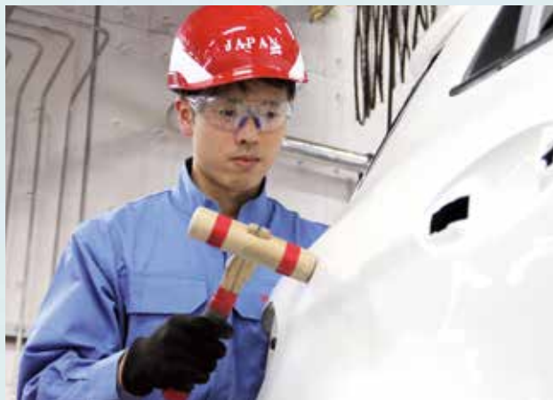
▲国際大会に向け、トヨタ技能者養成所で特訓中の加藤さん。損傷した車の外板をたたいて修理する課題に取り組む。
