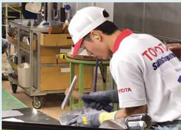
▲第56回技能五輪全国大会の様子。与えられた図面を基に、一枚の鋼板を手加工により成形し溶接により組み立てる。
