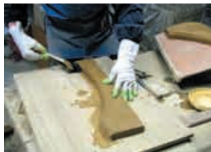
⑥カキヤブリで傷付けた部分をミズバケ（水を浸けた刷毛）で湿らす。
