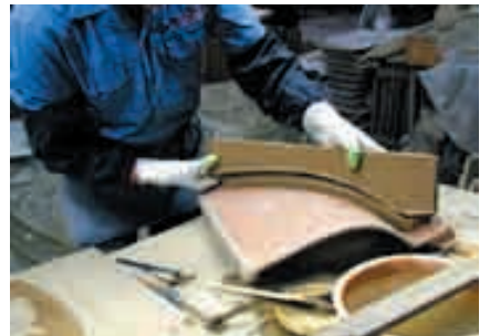
⑦瓦素地と垂れの傷つけた部分を合わせるようにして接着する。
