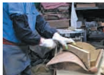
⑨垂れの木型に合わせて、余分な粘土をマルガマ（丸鎌）で切り落とす。
