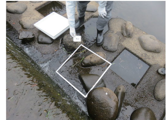
調査地点で 50 cm 角のアルミフレームを設置
