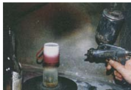
スプレーガンで絵具を吹き付ける（ボカシ吹き） 『上絵付け技術基礎』（多治見市陶磁器意匠研究所）
