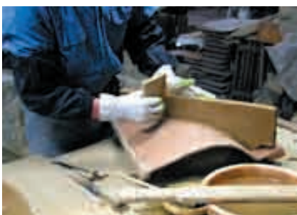
⑧ミズベラ（水を浸けたヘラ）で、接着部分を撫で整える。
