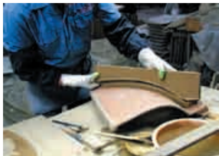
⑦瓦素地と垂れの傷付けた部分を合わせるようにして接着する。
