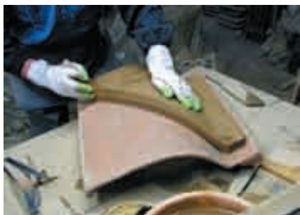
⑤垂れとの接着面をカキヤブリで傷付ける。
