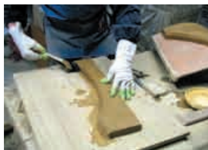
⑥カキヤブリで傷付けた部分をミズバケ（水を浸けた刷毛）で湿らす。
