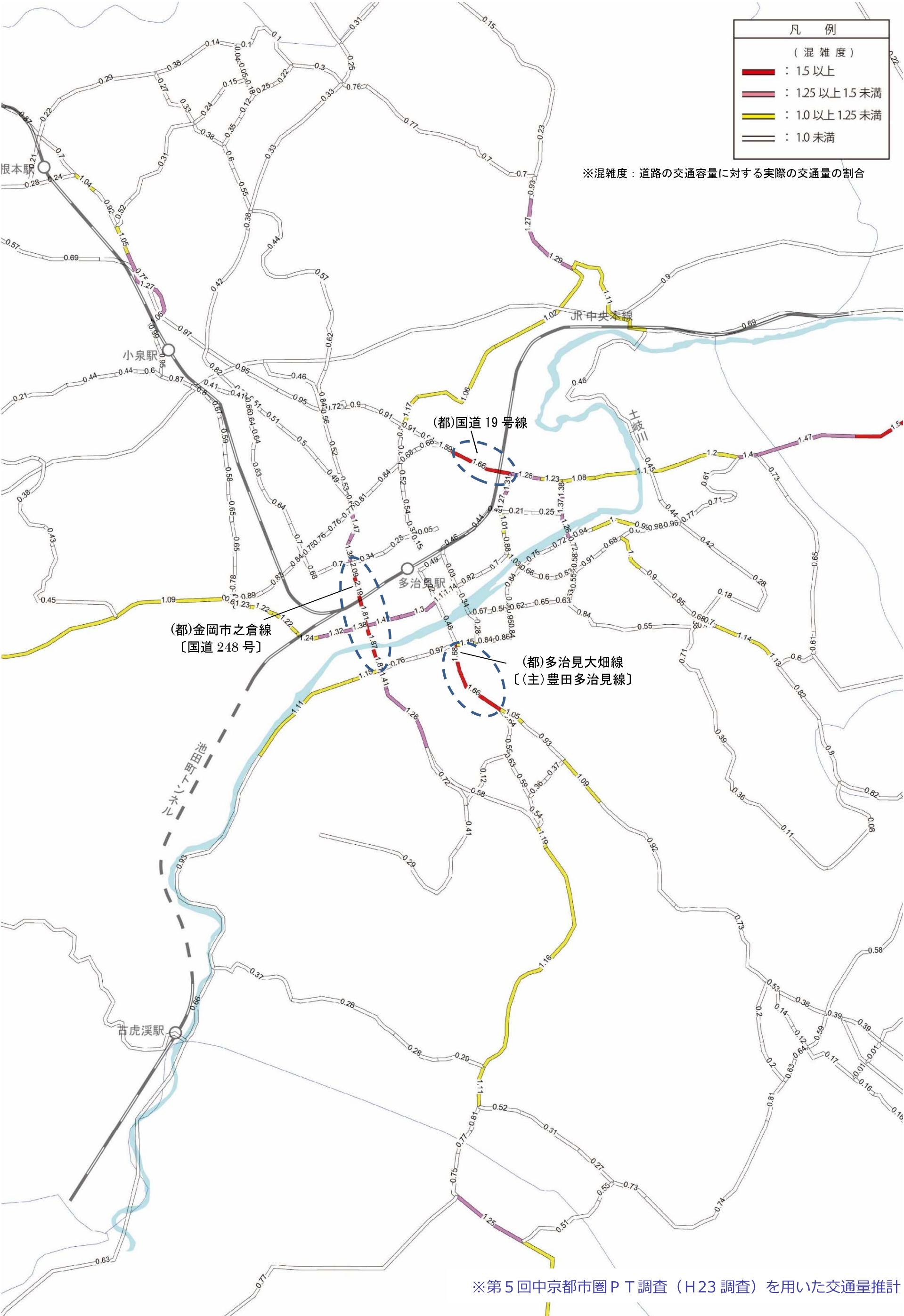
図 3・8 現況道路網に対する将来交通量推計結果〔混雑度図〕
