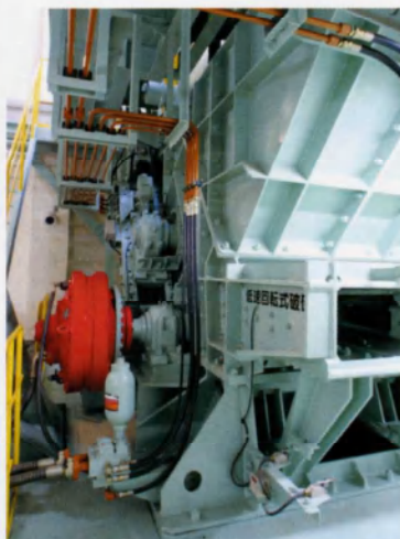
■低速回転式破碎機 二軸式の回転刃にごみを挟み込んで、一定の大きさに砕きます。
