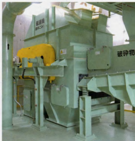
■磁選機（破碎ごみ用） 破碎されたものの中から鉄類を取り出します。
