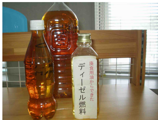
じゅんぐり2号：バイオディーゼル燃料 収集したてんぷら油を処理し、収集車の燃料として利用しています。
